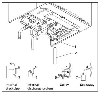
Fig. 5.11 Condensate discharge
