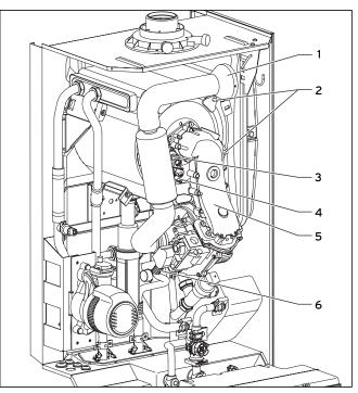
Fig. 8.2 Dismantling compact thermal module
