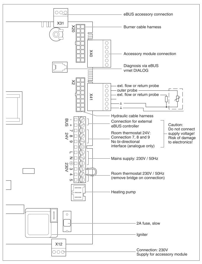
Fig. 4.9 Connection wiring
