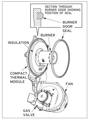
Fig. 8.7 Compact thermal module
